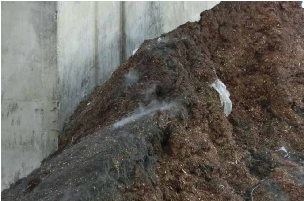
Ökad uppvärmning nära stödmur.
